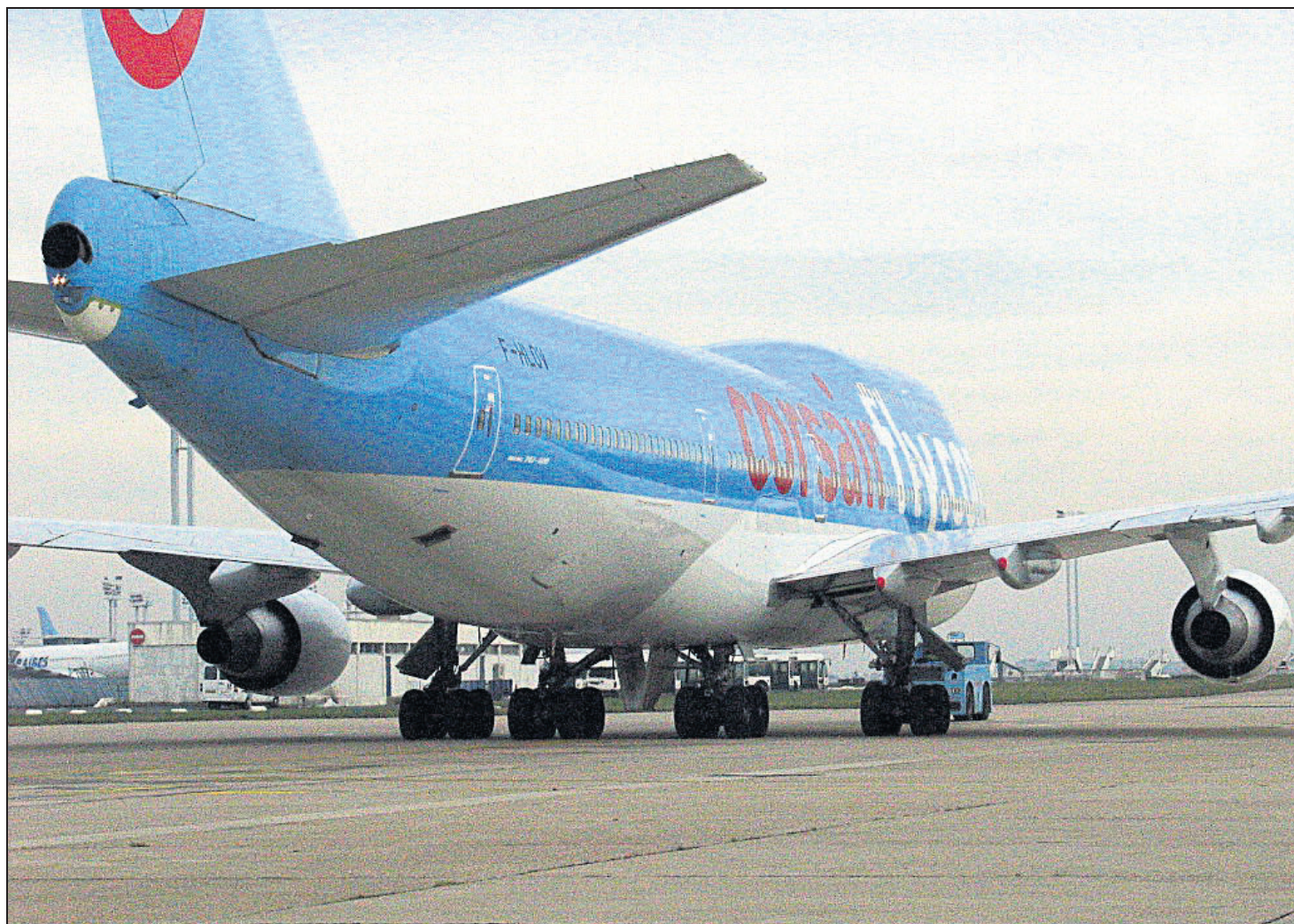
ORLY, MERCREDI. C'est cet avion de la compagnie Corsair qui a été endommagé au décollage le 10 décembre, la queue de l'appareil ayant touché la piste. La petite partie blanche (à gauche) témoigne de la réparation effectuée depuis sur le Boeing. (LP/V.V.)
